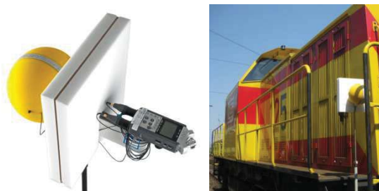
Abbildung 3: Kopfbezogenes Aufnahmegerät; rechts im Einsatz auf dem Mitfahrstand
