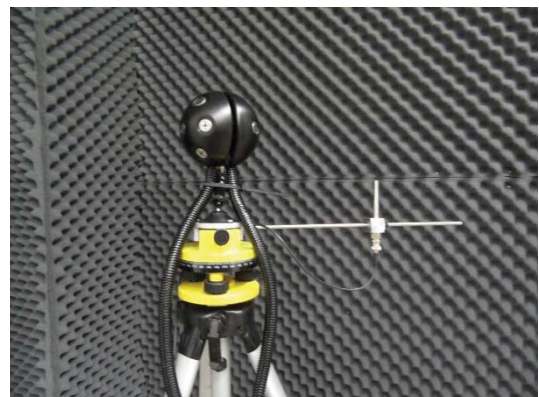
Abbildung 2: Schallsender bestehend aus 14 Lautsprechern, die auf einer Kugel (Durchmesser 10cm) angeordnet sind. Die Anordnung der Lautsprecher (14x0,5W) ermöglicht eine gleichzeitige und gleichmäßige Schallabstrahlung in alle Raumrichtungen. Mikrofon AVM MI17 1/4 Zoll Elektret Kondensator Mikrofon
