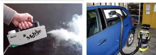
Abbildung 3: Dichtigkeitsprüfung der Fahrgastzelle mittels Nebel und Unter- oder Überdruck
