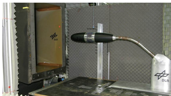
Abbildung 2: Foto der Messstrecke mit dem Mikrofonrechen und der Referenzschallquelle
