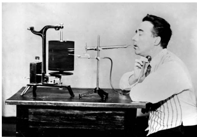
Abbildung 4: G. PANCONCELLI-CALZIA demonstriert die Anwendung eines Labiographen. Parallel dazu erfolgt die Aufzeichnung des Kehltones mit Hilfe einer MAREYSchen Kapsel. Aufzeichnungsgerät ist ein Kymograph mit einer Trommel, die mit rußgeschwärztem Papier bespannt ist. Reproduktion nach einem Glasplatten-Negativ in der historischen akustisch-phonetischen Sammlung (HAPS) der TU Dresden.
