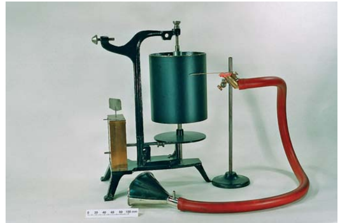
Abbildung 1: Einfache Ausführung eines Kymographen nach ZUNTZ. Das Gerät ist hier durch einen Mundtrichter, einen Schlauch und eine „Oreille inscriptice“ nach ROUSSELOT zu einem Messplatz für die Aufzeichnung des Phonationsstromes komplettiert worden. HAPS Dresden, Fotografie von R. DIETZEL aus [1].
