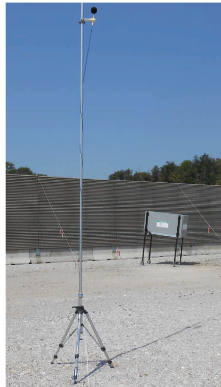
Abbildung 5: Messung an Lärmschutzwand
