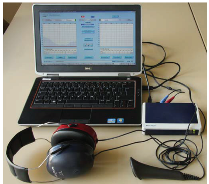
Abbildung 2: Maico Audiometer MA 33 in Verbindung mit einem Notebook zur Bestimmung der individuellen Schalldämmung eines Gehörschützes.
