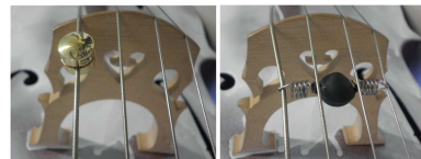
Abbildung 6: Zwei passive Tilger zur Eliminierung des Wolftons, befestigt an den Saiten zwischen Steg und Saitenhalter [5].
