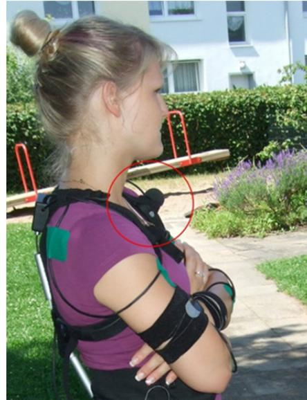
Abbildung 1: Anbringung des Lärmdosimeters am Gurtsystem
