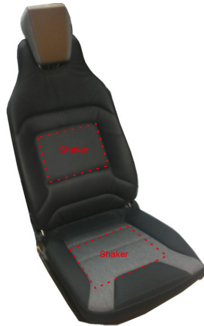
Abbildung 1: Fahrzeugsitz mit elektro-dynamischen Shakern.
