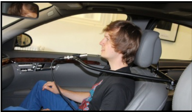
Abbildung 1: Die Position des Mikrofons am Beifahrersitz während der Sprachaufnahmen.
