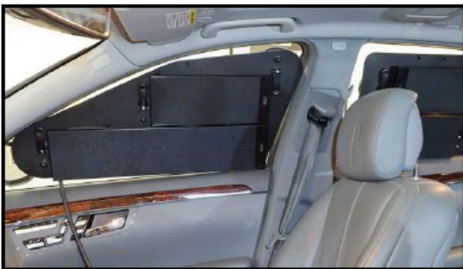
Abbildung 2: Die Positionen der Lautsprecher an den Fenstern der rechten Fahrzeugseite während der Sprachaufnahmen.
