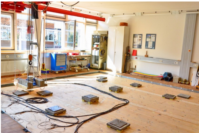
Abbildung 1: Deckenprüfstand der Hochschule Rosenheim
