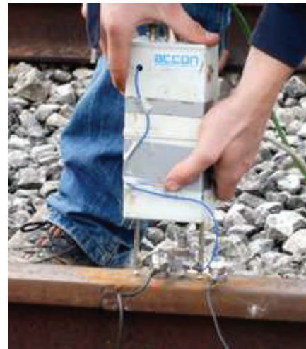
Abbildung 9: Automatischer Impulshammer am Startpunkt der Messreihe nach Abbildung 7
