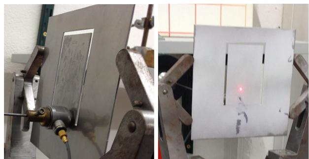
**Abbildung 7:** Beispielaufbau einer Metallzunge für Messung mit einem Laser: Anregung mit dem Shaker (links) und Laserpunkt auf der Zunge (rechts)
