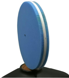
Abbildung 4: Jecklin-Scheibe mit angebrachtem Schaum
