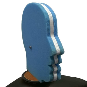
Abbildung 3: T-Disk mit angebrachtem Schaum
