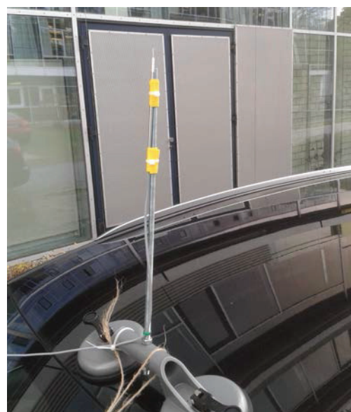
Abbildung 2: Montage des Strömungssensors
