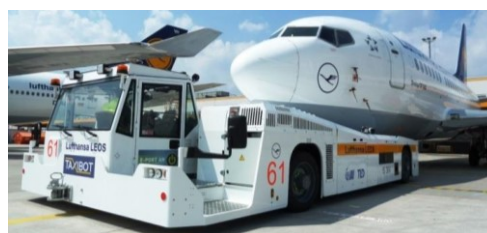
Abbildung 1: Hybrid-Flugzeugschlepper „TaxiBot“ mit angekoppelter Boeing B737-500. [Quelle: Lufthansa LEOS]
