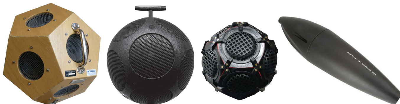
Abbildung 1: Untersuchte Schallquellen (Auswahl): Norsonic Typ 229, Outline Globesource, Selbstbau, Brüel & Kjær Omnisource.
