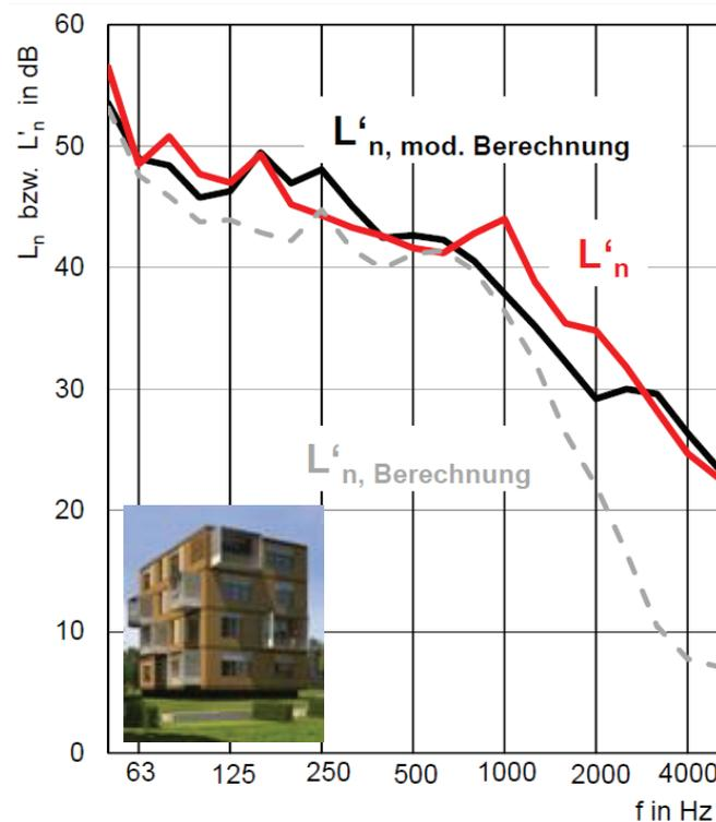
**Abbildung 8:** Vergleich zwischen Messung und Berechnung für ein Bauvorhaben in Massivholzbauweise. Auswertung der Einzahlangabe in 1/10 dB nach ISO 717-2
