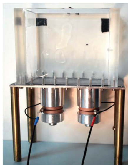
Abbildung 1: Bild der verwendeten Küvette: Länge 140 mm, Breite 70 mm und Höhe 130 mm, Wände aus PMMA und Boden aus Edelstahl. Resonanzfrequenzen der am Boden angebrachten Schallwandler liegen etwa bei 25 kHz und bei 45 kHz.
