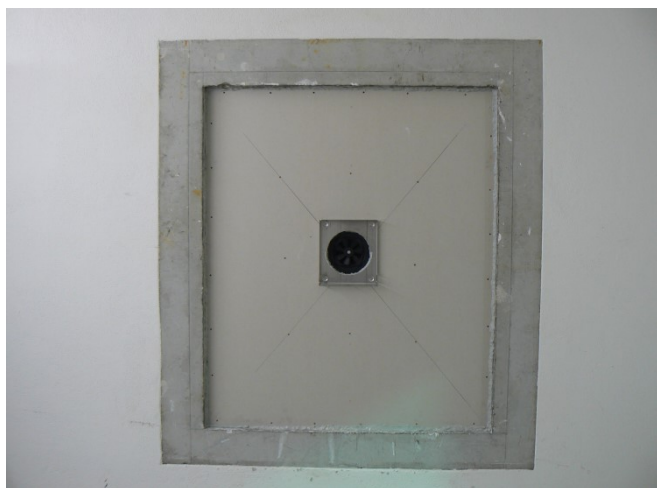
Abbildung 3: Dezentrales Lüftungsgerät im Fensterprüfstand der HFT Stuttgart.
