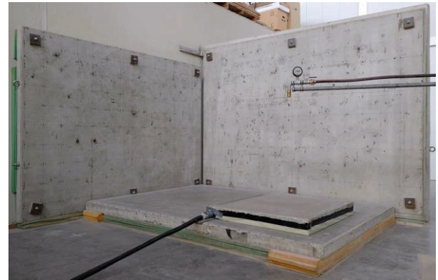
Abbildung 1: Charakterisierung eines bodenebenen Duschelements am Empfangsplattenprüfstand.
