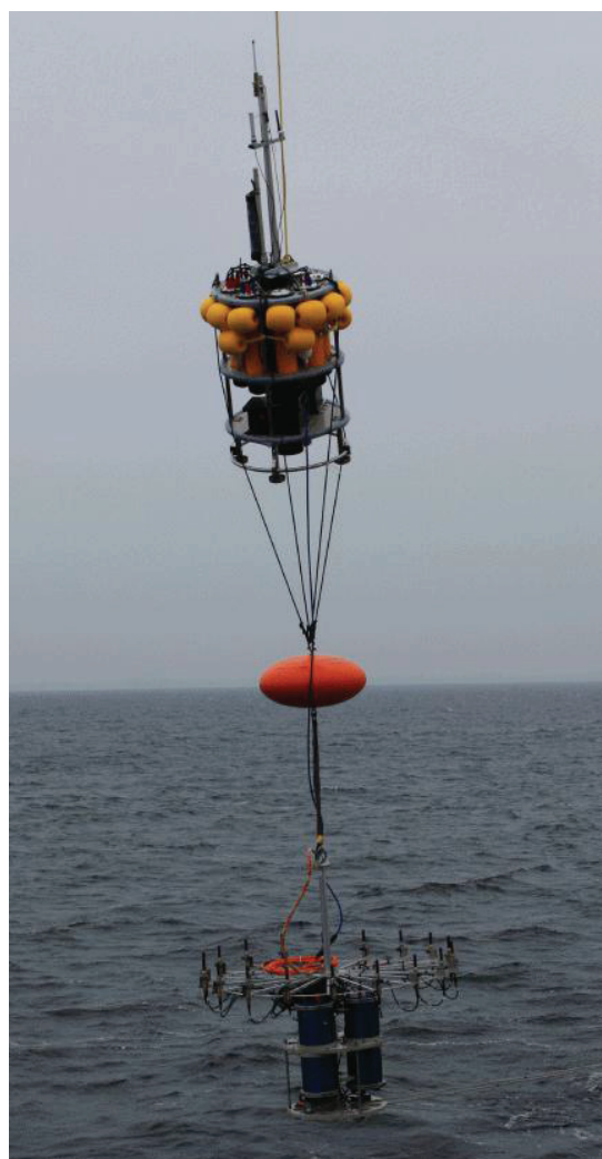
Abbildung 1: Die Driftboje, oben die Oberflächenboje mit Kommunikationsmast, unten das Kreisarray, dazwischen ein zusätzlicher Auftriebskörper.
