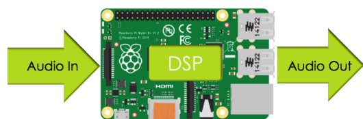
Abbildung 1: Grundkonzept für ein Effektgerät auf Basis des Raspberry Pi
