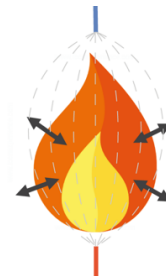
Abbildung 1: Prinzipskizze eines klassischen Plasmahochtöners mit einer modulierten Plasmaflamme zwischen zwei Elektroden.
