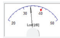
Abbildung 10: Beispiel für die Darstellung des Kavitationsrauschpegels in der praktischen Anwendung
