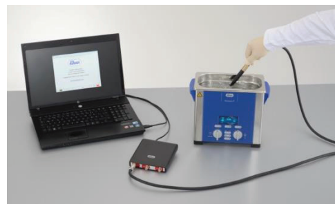
Abbildung 2: Aufbau zur Messung des Kavitationsrauschpegels mit Ultraschallgerät, Hydrophon, Vorverstärker, AD-Wandler und PC.
