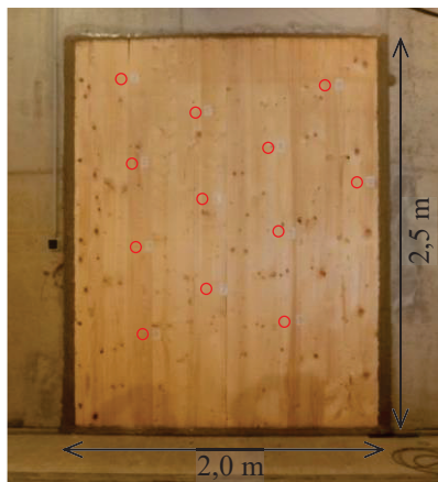
Abbildung 2: Der eingebaute Prüfkörper vom Senderaum aus gesehen. Die roten Kreise markieren jene Punkte, an denen der Schalldruckpegel zur Ermittlung des Intensitäts-Schalldämm-Maßes nach EN ISO 15186-3 gemessen wurde.
