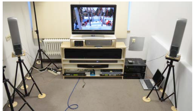
Abbildung 1: Hörversuchsumgebung; Aufstellung der Wiedergabegeräte
