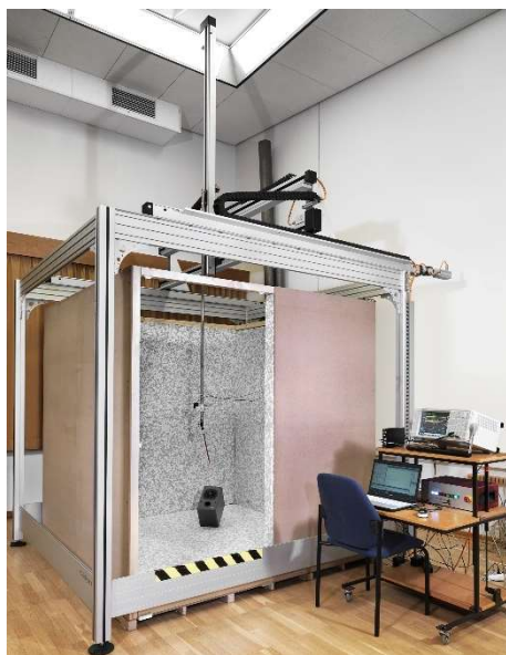
Abbildung 2: Portalscanner in der PTB; Untersuchungsumgebung zur räumlich hochaufgelösten Charakterisierung von Ultraschallfeldern an einem Referenzarbeitsplatz
