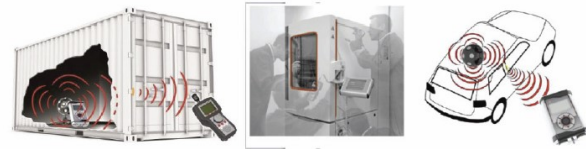
Abbildung 1: Prinzipdarstellung möglicher Anwendungen der aktiven Ultraschallmethode in der Industrie, Schallsender und Empfänger befinden sich hinter oder vor der zu untersuchenden Dichtung.
