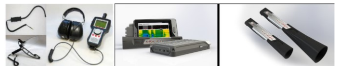
Abbildung 2: klassische Prüftechnik zur Lecksuche und Dichtheitsbewertung. Links: klassische analoge Prüftechnik mit Schmalbandverfahren und Zubehör. Mitte u. Rechts: Digitales Prüfgerät mit ausgewähltem Zubehör für Dichtheitsanwendungen. Die Softwarearchitektur erlaubt die Integration spezialisierter Programme und Abläufe für die Dichtheitsprüfung. Ein wichtiges Feature für den Einsatz ist eine geeignete Transformation in den hörbaren Frequenzbereich.
