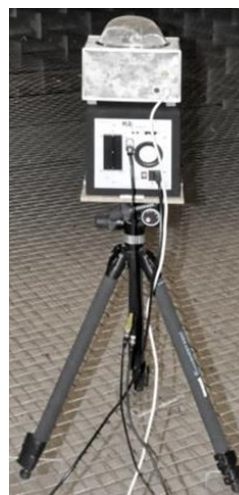
Abbildung 5: Funkengenerator und Lautsprecher auf Stativ, Foto: GFaI e.V.
