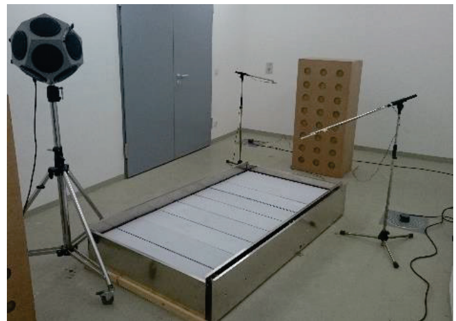
Abbildung 4: Bestimmung der Absorption im Nachhallzeitverfahren
