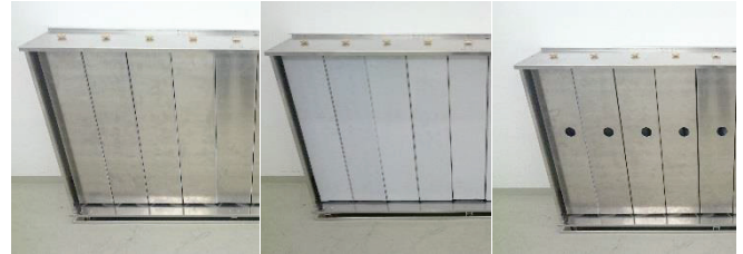
Abbildung 2: Zustände des Testmoduls (von links: schallhart, absorbierend, Resonator)
