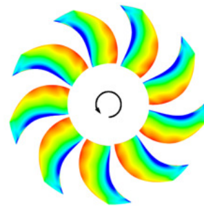
Abbildung 8: Druckverteilung an der Saugseite der Laufradschaufel für Ursprungsgeometrie
