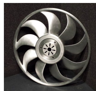
Abbildung 10: Ansicht des optimierten Laufrades
