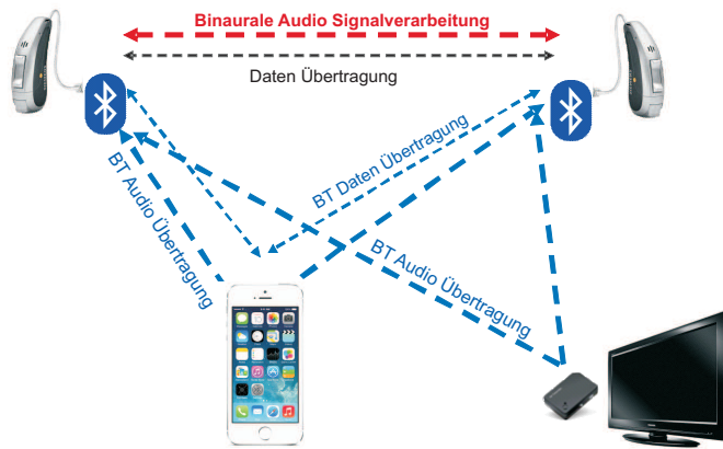
Abbildung 8: Connectivity 3.0: Magnetische Übertragungstechnologie zwischen den Hörgeräten kombiniert mit Bluetooth Technologie, die zur Anbindung an externe Geräte, z.B. Smartphones, in Hörgeräte integriert ist.
