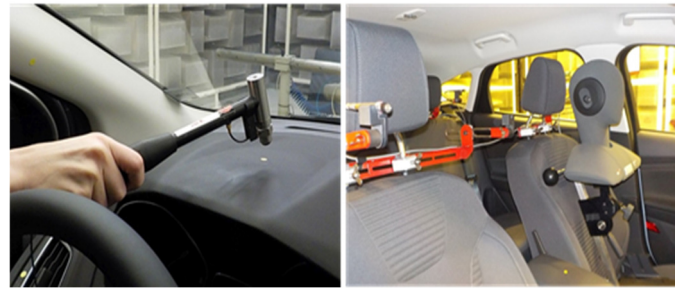
Abbildung 4: Messung der NTF für den Klopfest. Anregung mit Impulshammer, Messung an vier Ohrpositionen und mit dem Kunstkopf.
