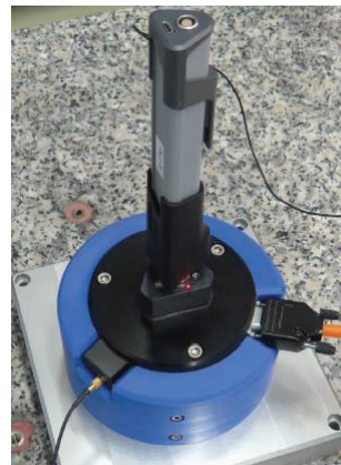
Abbildung 5: Schwingregelsystem: VCS 403 (sinus, Rauschen), Referenzsensor: Laservibrometer, PCB M353B17, Leistungsverstärker: PA14-500, Schwingungserreger: SE-11, SE-16, piezo-Erreger
