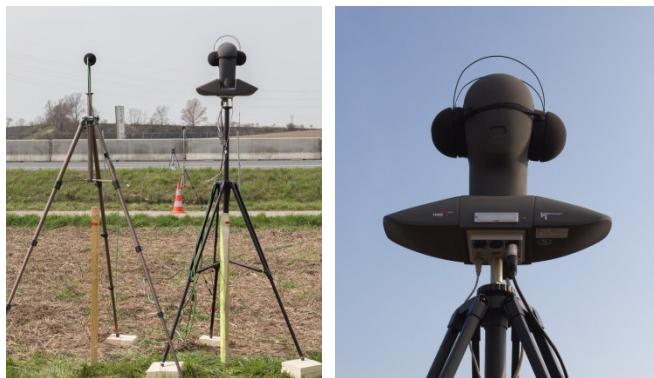
Abbildung 2: Immissionsmessungen mit Mikrofon und Kunstkopf in 25 m Entfernung zum Rumpelstreifen und 1,2 m über der Fahrbahnoberfläche.
