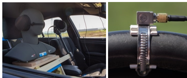
Abbildung 3: Messung der akustischen Wirkung mit Kunstkopf und Mikrofon (links) und der hervorgerufenen Vibrationen am Lenkrad mit 3-achsigem Beschleunigungsaufnehmer (rechts) im PKW.
