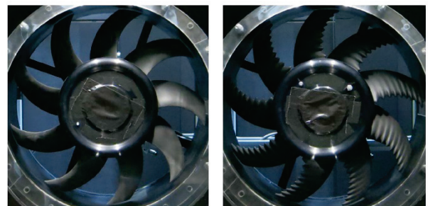
Abbildung 2: Vorwärtsgesichelter Ventilator mit gerader Vorderkante (links) und sinusförmiger Vorderkante (rechts)
