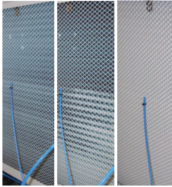
Abbildung 8: Verdampfer, links: nicht vereist, mitte: halb vereist und rechts: vollständig vereist.
