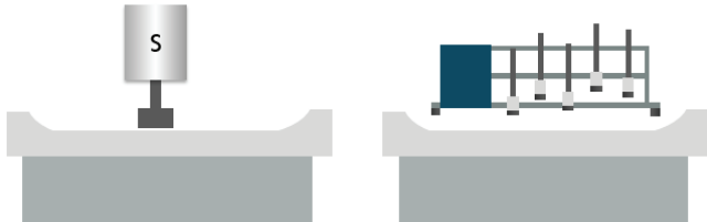
Abbildung 4: Körperschallquellen am Beispiel der Duschwanne mit Wannenträger. Anregung mit Shaker (links) sowie Normhammerwerk (rechts).
