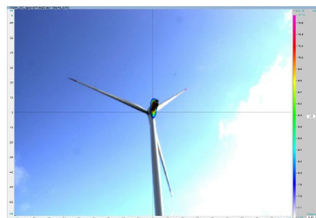
Abbildung 11: Lokalisierung der konstanten Frequenz (4,5 kHz) auf der Gondel. Maximale Intensität: 10 dB, Bildausschnitt: X = 186 m, Y = 138 m, Abstand zur WEA: 172 m
