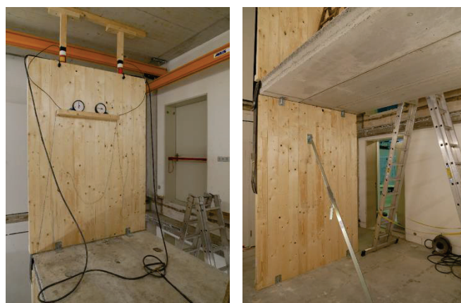
Abbildung 1: T-Stoß aus Brettsperrholzwänden und Spannbeton-Fertigdecke im Deckenprüfstand - obere Wand mit Hydraulikzylindern zur Simulation einer Auflast (links) und untere Wand mit Deckenunterseite (rechts) - die im rechten Bild sichtbaren Verbindungswinkel zwischen Wand und Decke wurden für die Messungen entfernt.
