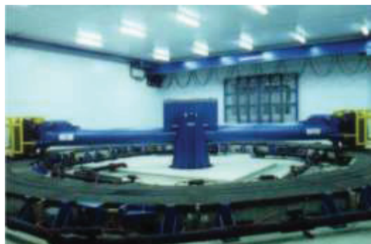
Abbildung 1: Rundlaufprüfstand der STUVA. Zentral angeordneter Antrieb von zwei Lkw-Rädern mit jeweiliger Last von ca. 50 kN
