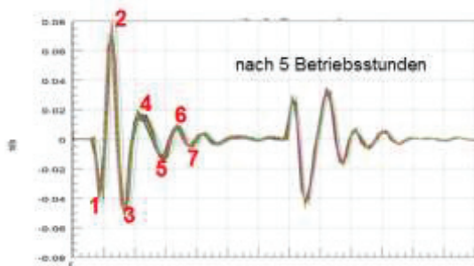
Abbildung 8: Überlagerung der Schwingensignale an einer Messposition auf einer 280mm starken Platte mit „weichem“ Untergrund bei 20 aufeinander folgenden Überfahrten bei ca. 13.000 Überfahrten
