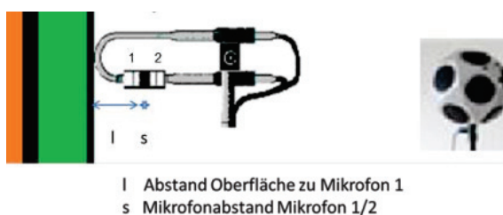
Abbildung 2: Schallintensitätssonde vor Absorber mit senkrechtem Schalleinfall
