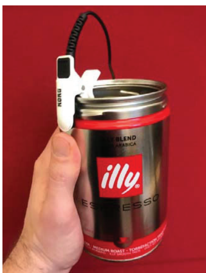
Abbildung 1: Klemmontage eines Piezosensors zur Aufnahme des Vibrationssignals, z.B. an einer Kaffeedose.
