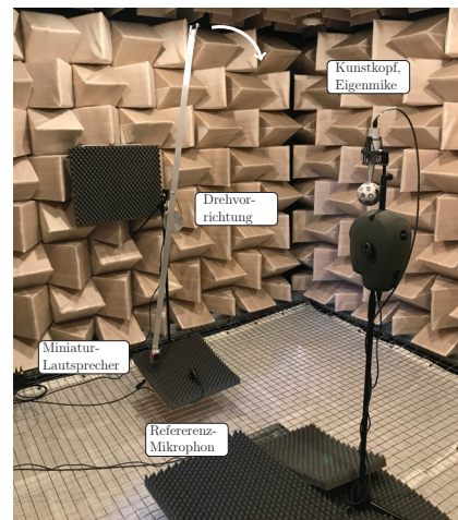
Abbildung 7: Foto des Aufbaus zum Erstellen von Testaufnahmen im reflexionsarmen Raum des IKTs.
