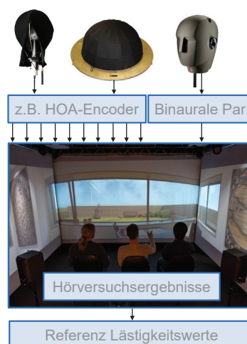
Abbildung 2: Flußgraph des Vorgehens zum Gewinn von Referenz-Lästigkeitswerten aus Probandenversuchen.
