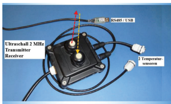
Abbildung 7: Eine Ausführungsvariante des Akustiksensors. Der Betrieb erfolgt dabei über eine RS 485/USB-Schnittstelle. Zwei Sensoren erfassen die Wassertemperatur in der Umgebung, was eine sichere Bestimmung der Schallgeschwindigkeit im Wasser ermöglicht.
