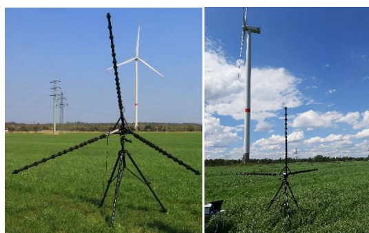
Abbildung 2: links: Akustische Kamera mit 48 Mikrofon-Stern-Array und Videokamera in der Mitte; rechts: Messaufbau während einer Messung an WEA1
