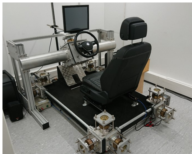
Abbildung 1: Vibrationsplattform für die Simulation von Ganzkörper- und Lenkradvibrationen
