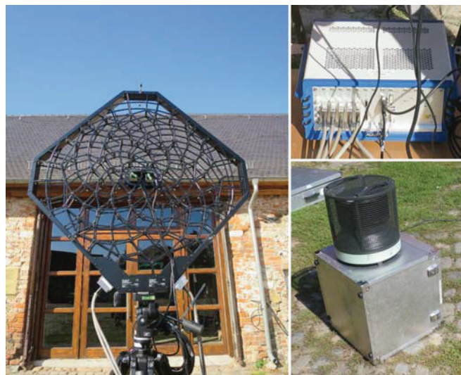
Abbildung 5: Akustische Kamera der GFaI im Einsatz (hier Array mit 72 Mikrophonen, Unten rechts ist eine kleineres System (mit weniger Mikrophonen abgebildet). Rechts befinden sich der Datenrekorder (bis zu 168 Kanäle, 192 kHz bei 24 Bit) und die akustische Quelle für die Experimente (B&K Reference Sound Source - Typ 4204).
